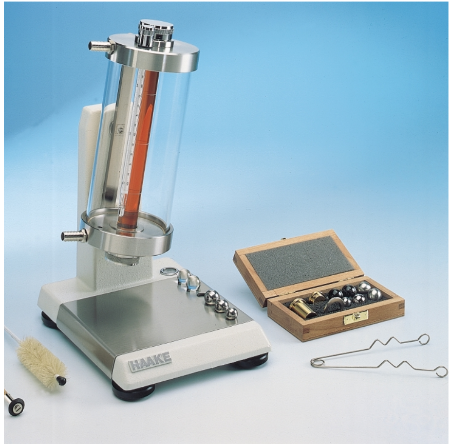
Falling-ball viscosimeter after Höppner (P 1.8.3.2)
